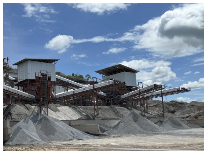
รูปที่ 2-22 ก. โรงโม่หินที่เป็นระบบปิด และมีการติดตั้งระบบสเปรย์น้ำ
